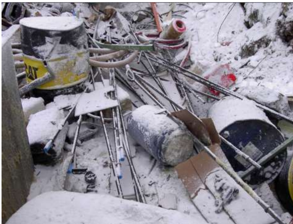
Figura 2: Bombola GPL ritrovata tra i resti del container con il rubinetto di erogazione aperto
