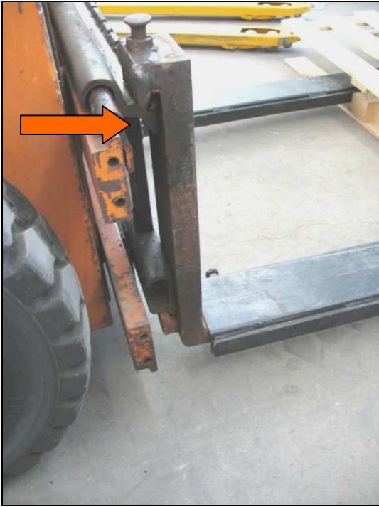
Figura 4: Forca destra – posizione extracorsa con l'allestimento di cui alla figura 3
