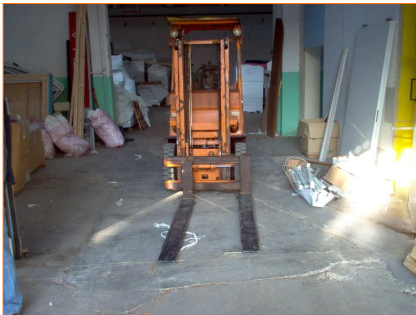
Figura 8: Forca destra non agganciata alla piastra di supporto
