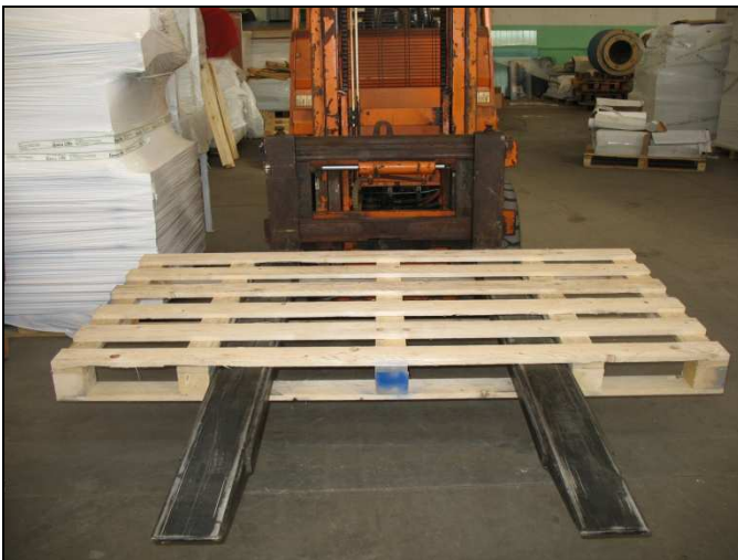
Figura 6: Carrello elevatore e bancale con dimensioni compatibili fra loro
