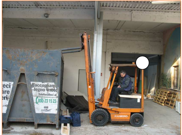
Figura 2: Posizione delle forche ed inclinazione del castello del carrello elevatore in fase di scarico all’interno del container. Al momento dell’infortunio, il carrello, col suo carico, si trovava tra il pilastro e la parete dell’immobile.
