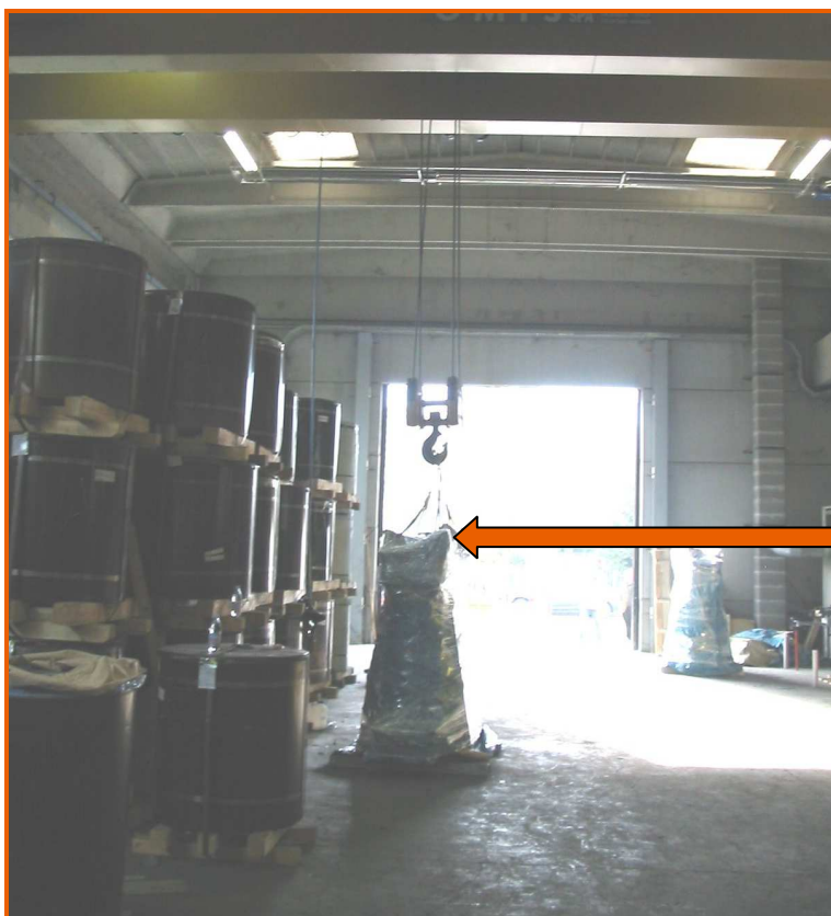
Nucleo di trasformatore agganciato al carroponete
