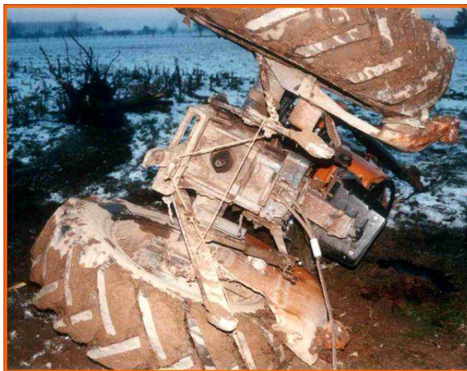
Il trattore viene riportato in posizione normale. Si nota che il cavo d'acciaio è fissato al gancio più alto del retro del trattore, posto più in alto del mozzo delle ruote posteriori.
