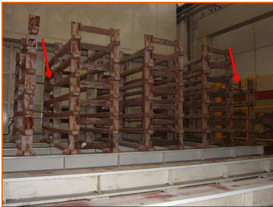
Figura 5: particolare di un castello vuoto con i telai centrali saldati a coppie e i telai di estremità non saldati; le frecce rosse indicano i distanziali mobili
