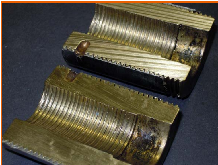
Filettatura di accoppiamento rovinata
