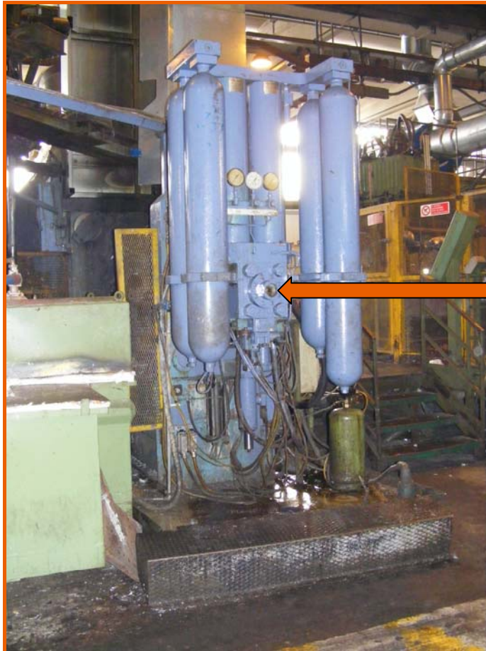
Macchina pressocolatrice con particolare del volantino di regolazione
