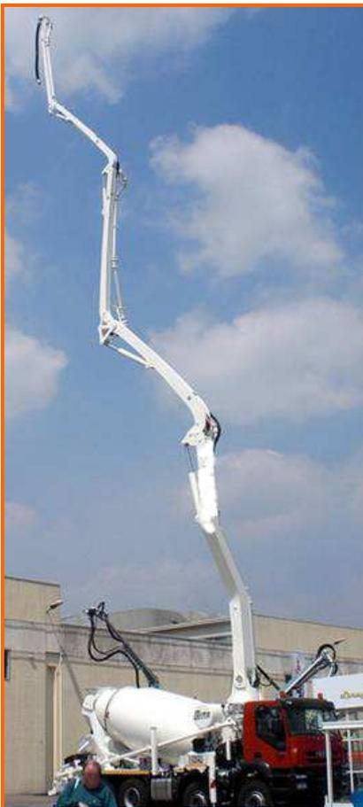
*Esempio di autobetonpompa con il braccio in posizione verticale*
