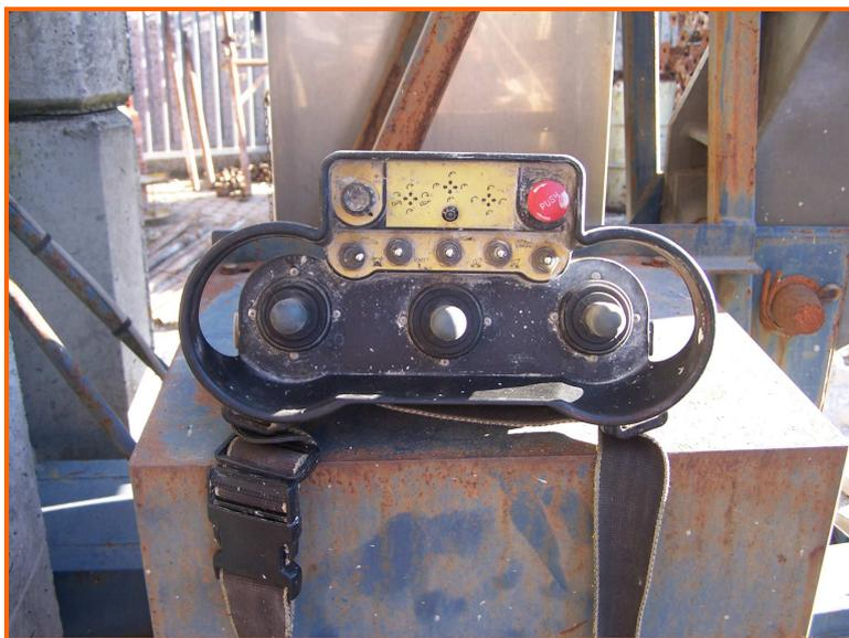
*Radiocomando utilizzato da Diego per manovrare i bracci dell'autobetonpompa*
